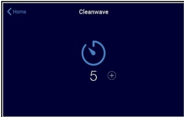
ホームスクリーンの **CleanWave** のアイコンを押すと **CleanWave** が作動し、スクリーン上に時計が表示されカウントダウンを始めます。時計横の+のアイコンを押して、時間を延ばすことができます。
