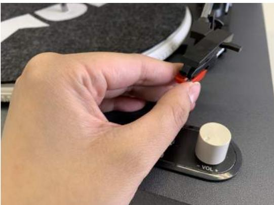
交換する針を取り付けます。針の奥側をカートリッジの溝に合わせて引き上げて下さい。
