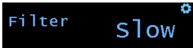
Filter 1- Slow Roll-off, Linear Phase は 高域でのフィルターリングを最小限にしなが
